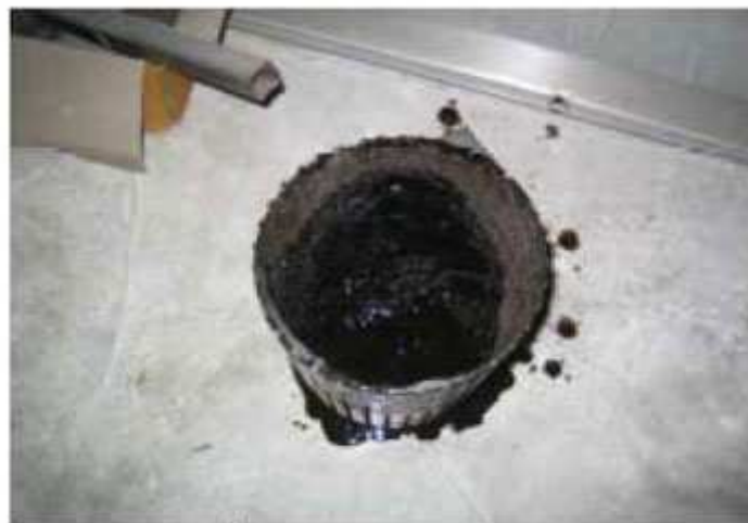
รูปกรองน้ำมัน (Strainer) ที่เกิดการอุดตัน
