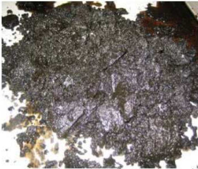
รูปถ่ายแข็งที่อยู่ในระบบท่อน้ำมันร้อนซึ่งอุดตันที่ กรองน้ำมัน (Strainer)
