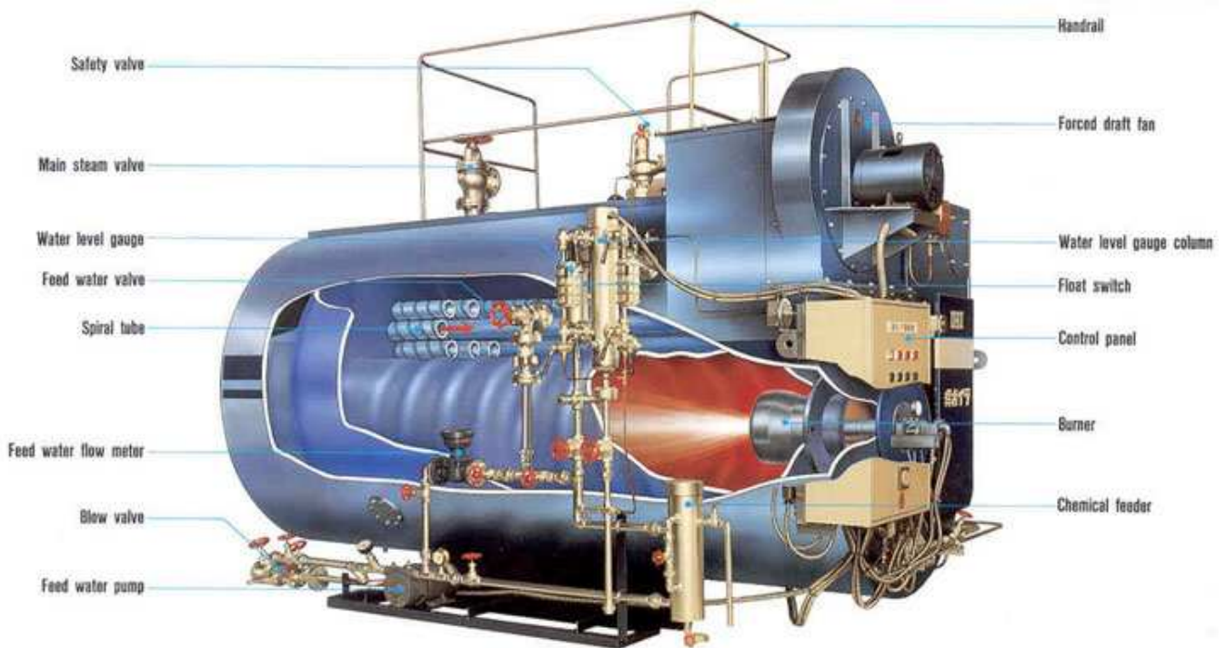
Boiler ขนาดกลางชนิดท่อไฟ ใช้ ก๊าซ น้ำมัน หรือ น้ำมันเตาเป็นเชื้อเพลิง
