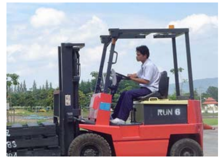
บนช่วงยกที่ความสูง 4,775 มม. ในขณะที่ยาง เต็มลม สามารถรับน้ำหนักได้เพียง 210 กก. ที่ ความสูง 4,300 มม.
